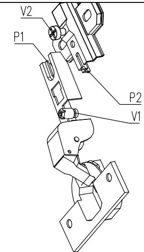
Канавка винта V1 должна войти в паз P2
